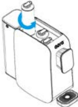
**2.** Das alte Filterelement gegen den Uhrzeigersinn drehen und nach oben rausziehen.
